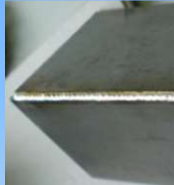
Ecknaht VA 2mm
