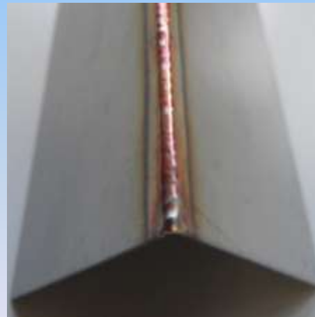
Ecknaht VA 0,4mm
