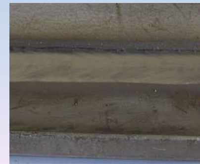
Kehlnaht VA 8mm
