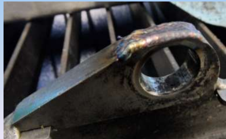
Auftragung VA WIG-Stab 2,4mm
