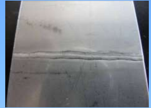
Stumpfnaht VA 0,6mm
