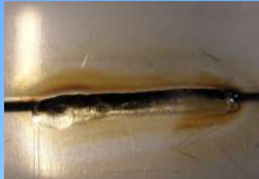
Überlappnaht VA 0,4mm
