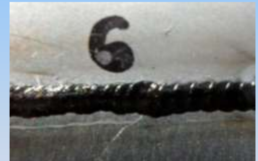
Überlappnaht Tantal 0,6mm
