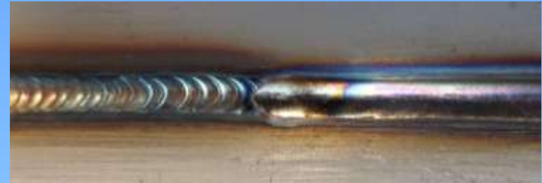
Kehlnaht 6mm VA WIG-Stab 3,2mm
