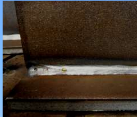
Stahl 12mm - 170cm/min.
