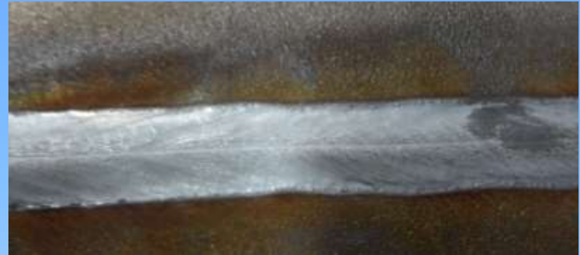
Stumpfnahht 8,0mm I-Stoß 2,0 mm Spalt Vollanschluss einlagig
