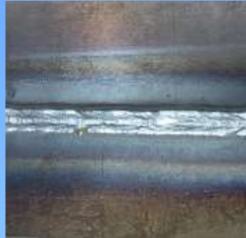
Kehlnaht 0,8mm / Draht 1,0mm
